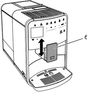
Abb. 11: Höhenverstellbarer Auslauf
