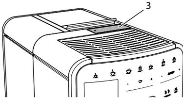
Abb. 9: Pulverschacht
